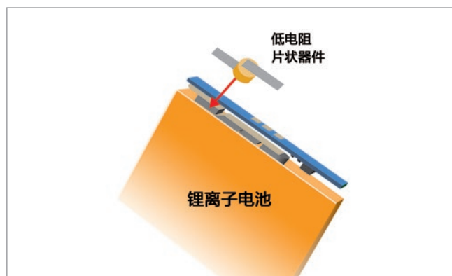
图 5.低 \rho MXP片状器件和表面贴装器件安装在PCB下面。（MXP片状器件的长度和构造也可按照客户要求定制。）
