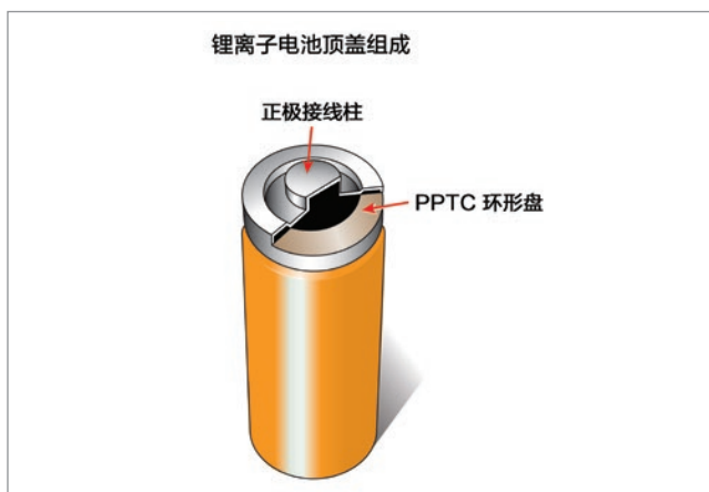
图 8. PolySwitch盘状器件在18650电池上的布置。
